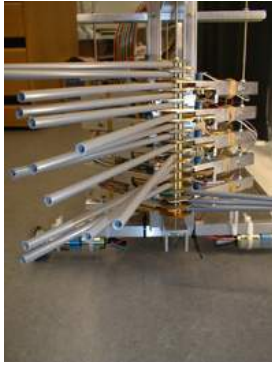
Eyebot im Anfangszustand. In den ungeordneten Röhren befinden sich Lichtsensoren.
